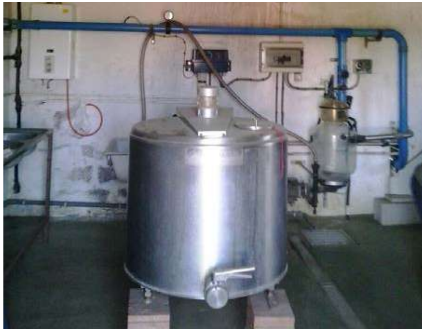
Fig. 3.3.19 ► Tanque de frío en la sala adyacente a la de ordeño.
