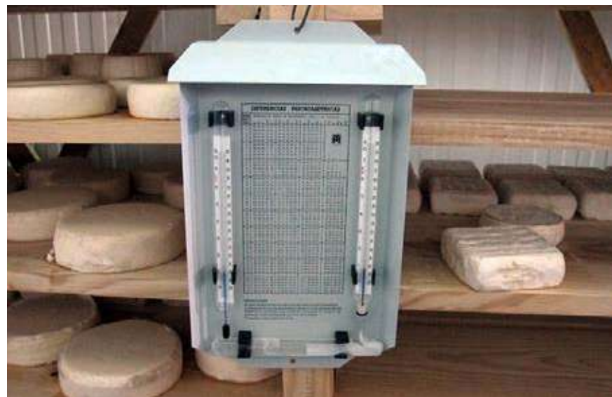
Fig. 23 ▶ Medidor de la humedad relativa en sala de maduración.
