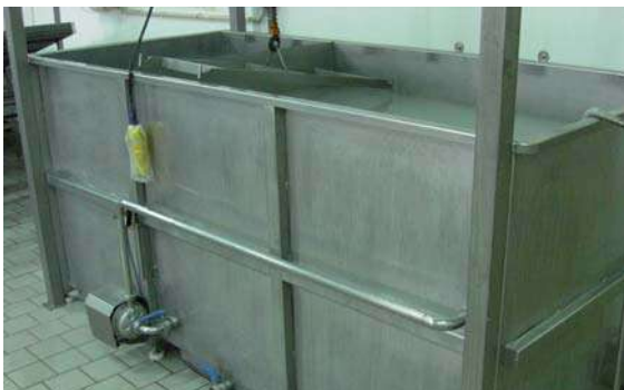
Imagen 5.1. Lavadora de moldes y moldes limpios.
