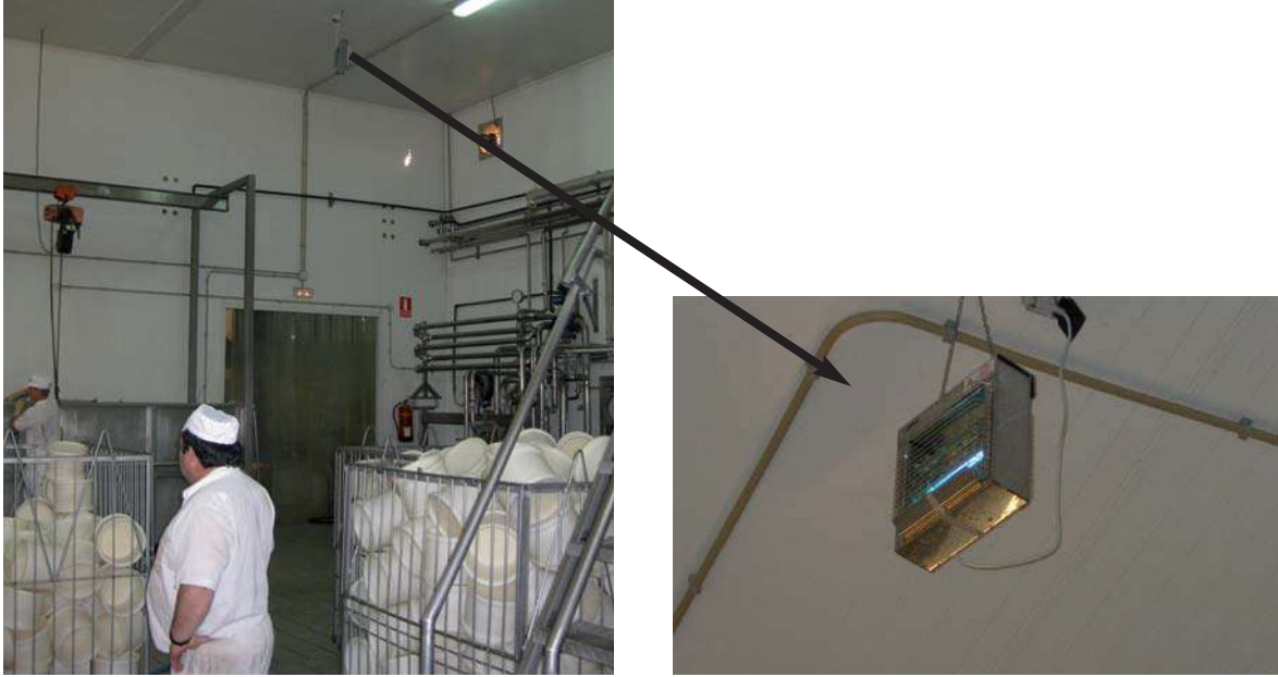
Imagen 5.5. Lámpara electrocutora y su ubicación en una sala de producción.
