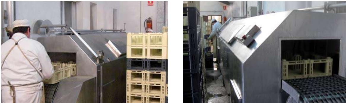
Imagen 5.2. Proceso de lavado de cajas.
