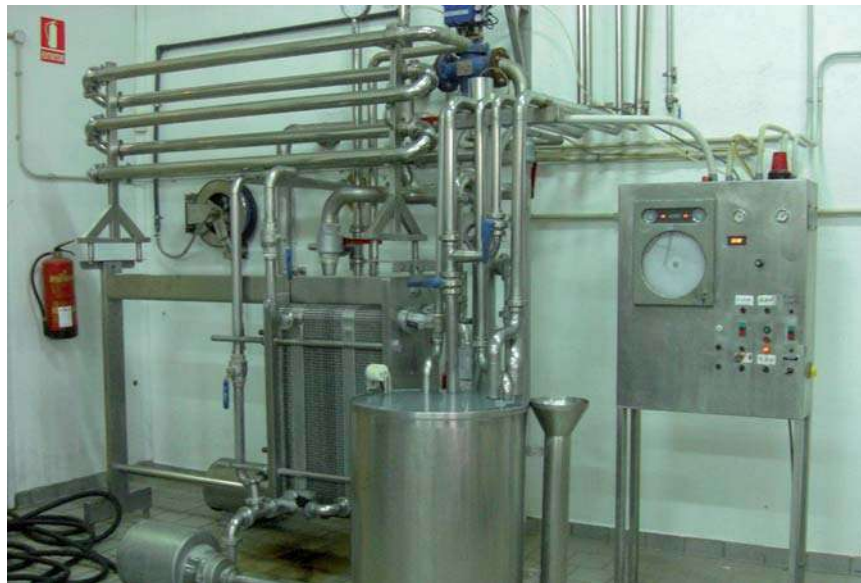
Imagen 6.3. Pasterizador y termógrafo.
