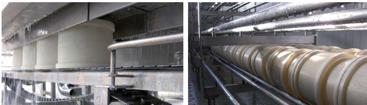
Imagen 6.6. Llenado de moldes y prensado de los quesos
