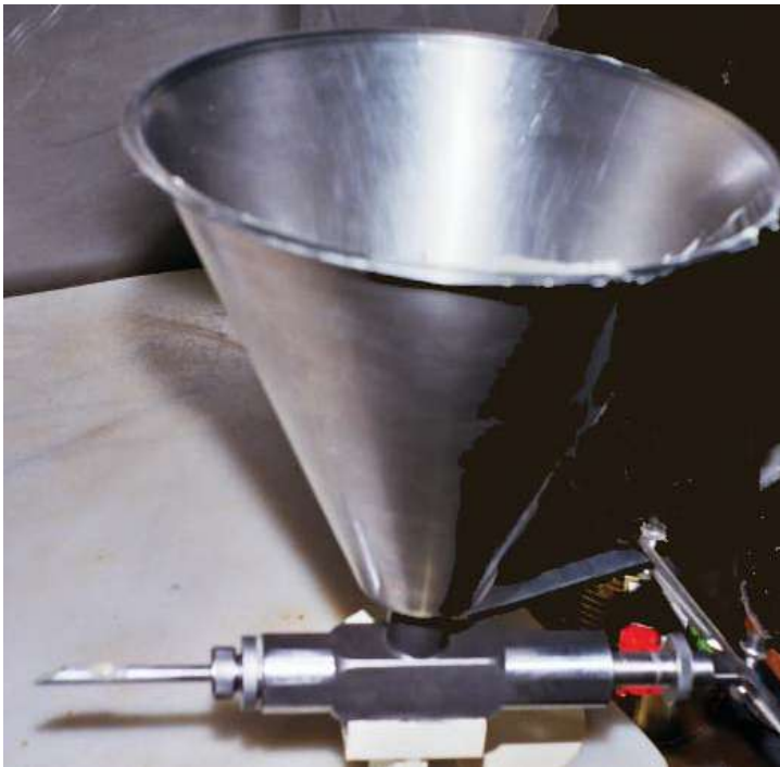
Fotografía 3.6: Inyectora de rellenos.
