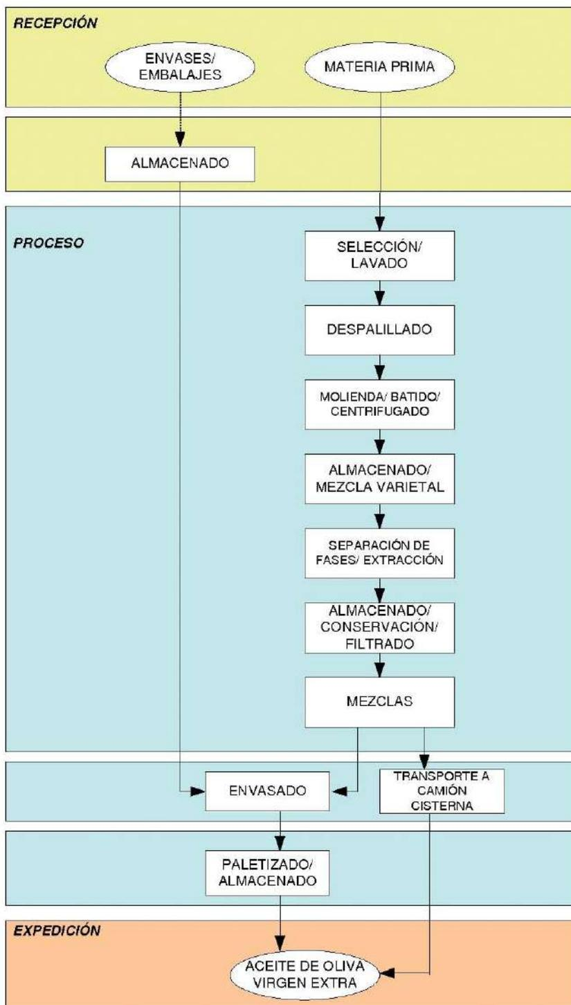
FIGURA 2. FLUJOGRAMA DEL PROCESO DE ELABORACIÓN DE DIFERENTES TIPOS DE ACEITES
