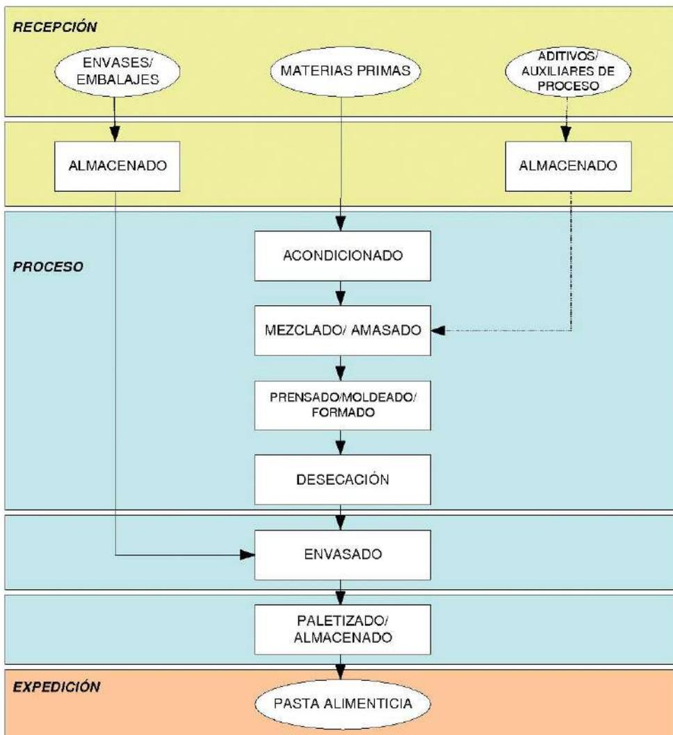
FIGURA 5. FLUJORAMA DEL PROCESO DE FABRICACIÓN DE PRODUCTOS DE PASTELERÍA- DE LARGA DURACIÓN
