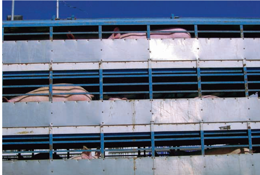
▲ Figura 20. Los vehículos de transporte de animales deben contar con una ventilación adecuada.
