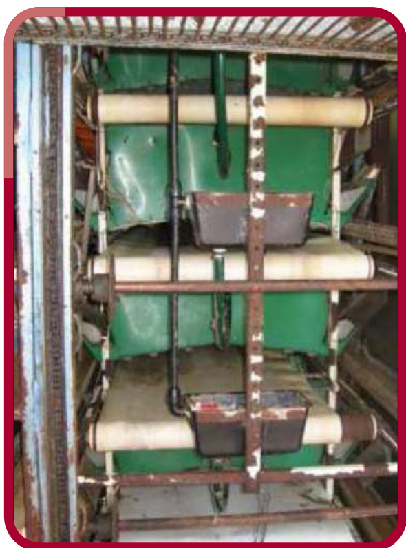
Fin de la cinta de recogida de gallinaza en una nave de jaulas, (zona de descarga de las deyecciones).
