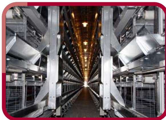
Sistema de tolvas para el reparto de pienso a lo largo de los comederos.
